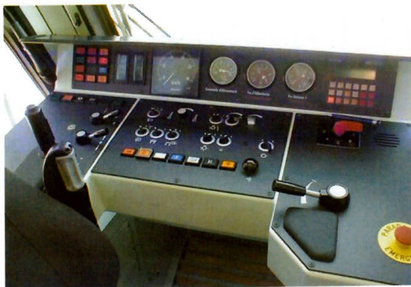
Figura 8 - Sistema de comando (controla os principais sistemas)
