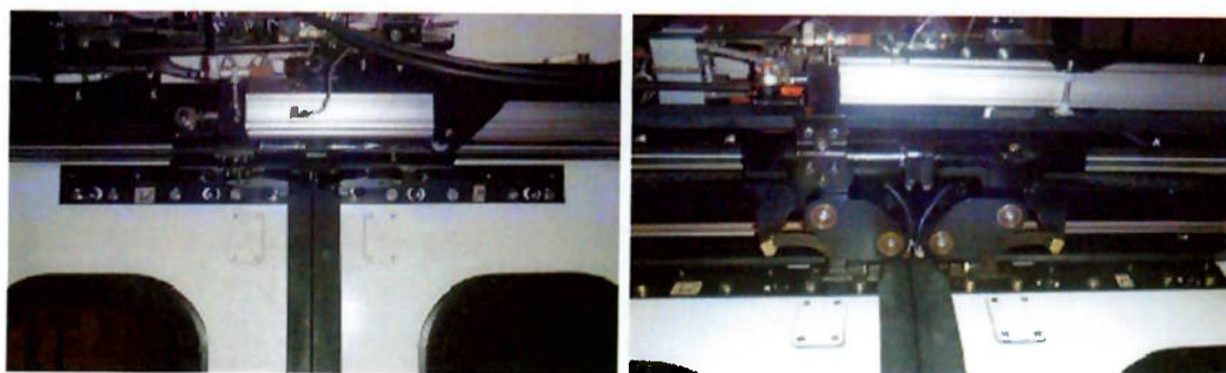
Figura 21 - Sistema de abertura e fechamento de portas
